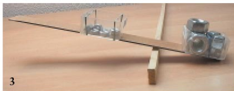
图 3: 本图中的支点与图 2 一样，但假如左边的物体与支点靠得太近，则右边的重物不再能被撬起。
