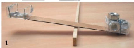
图 1: 在该图中，杠杆右边筐子中装载的五个大螺母无法被左边筐子中的六个小螺母撬起。
