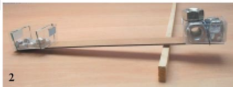
图 2: 若将支点向右移动，则可以将右边的重物撬起
